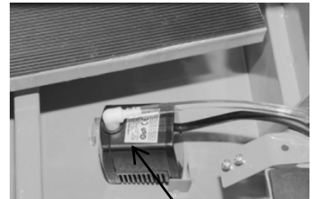
Pompa de apa
